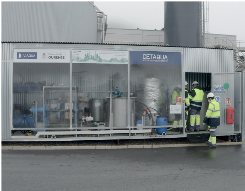
Figura 1. Prototipo piloto para la producción de AGV a partir de lodos de EDAR y biorresiduos urbanos del proyecto Ecoval
